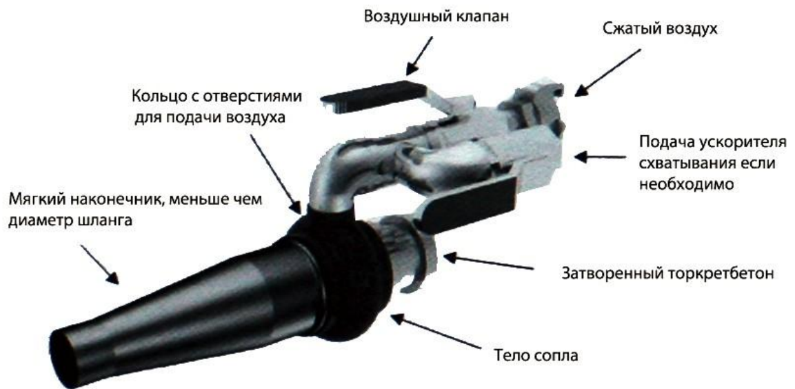
Рис 6.8 Конструкция сопла для мокрого торкретирования
