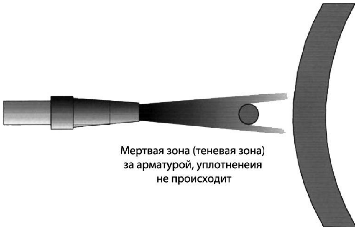
Рис. 8.10 За арматурой могут образовываться мертвые зоны из-за отсутствия потока.
