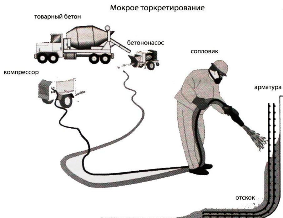
Рис. 4.2 Общая схема мокрого торкретирования. Все ингредиенты тщательно смешиваются, прежде чем прокачиваются оборудованием в напорный рукав. Сжатый воздух ускоряет смесь на выходе из сопла.
